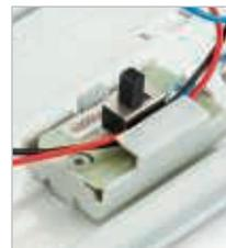
All-in: il commutatore di lumen integrato consente di selezionare facilmente i due flussi luminosi dell'apparecchio
