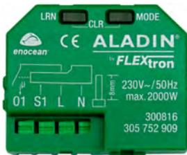
**Récepteur multiple encastré (ENC) ALADIN mini 1 canal 230 V**
