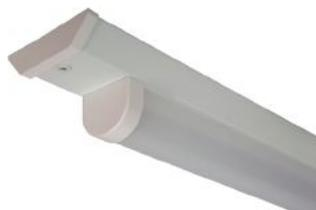
Luminaire LED linéaire universel s'adaptant sur différents systèmes de chemins lumineux présents sur le marché. Cette solution est optimale pour la rénovation d'installations existantes équipés en tubes T8 de 36 W ou de 58 W. Le nouveau luminaire linéaire universel se fixe à l'aide de pinces sur le chemin lumineux existant. Indice du rendu des couleurs IRC > 80
