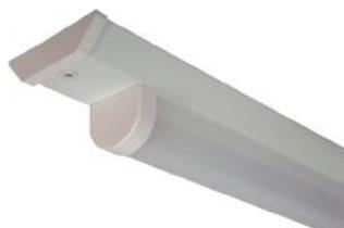
Luminaire LED universel convenant aux systèmes ZX1/ZX2 de Zumtobel. Cette solution est optimale pour la rénovation d'installations existantes équipés en tubes T8 de 36 W ou de 58 W. Le nouveau luminaire linéaire universel se fixe à l'aide de pinces sur le chemin lumineux existant. Indice du rendu des couleurs IRC > 80
