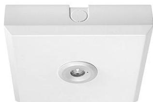
La série ELH propose un éclairage des voies de secours pour un fonctionnement avec une batterie individuelle, dont la construction des lentilles est spécialement conçue pour les zones étendues - soit pour un éclairage ellipsoïdal des couloirs, soit pour un éclairage circulaire des grandes pièces. Leur portée supérieure à la moyenne réduit le nombre de luminaires nécessaires. L'interface DALI intégrée assure une grande flexibilité de gestion pour le fonctionnement et une maintenance confortable.
