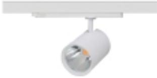
CoB LED, mit 3-Phasen-Adapter, im Adapter integriertes Netzteil 330° drehbar, 130° schwenkbar, 36° Reflektor, klares Schutzglas, Farbwiedergabeindex CRI >90
