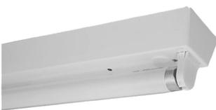
Stahl Zinkor 0.5 mm galvanisiert, pulverbeschichtet, für LED-Röhren T8, fertig verdrahtet auf Rotorfassungen mit T-Draht 1 mm<sup>2</sup> weiss, mit Anschlussklemmen für 230V
